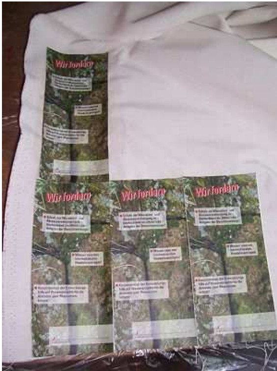
Bild: hinten links– Latex-Bindemittel (Stoff zuerst) vorn links – Latex-Bindemittel (Papier zuerst) vorn Mitte – Holzkaltleim (Stoff zuerst) vorn rechts– Teppichfixierung (Stoff zuerst)
